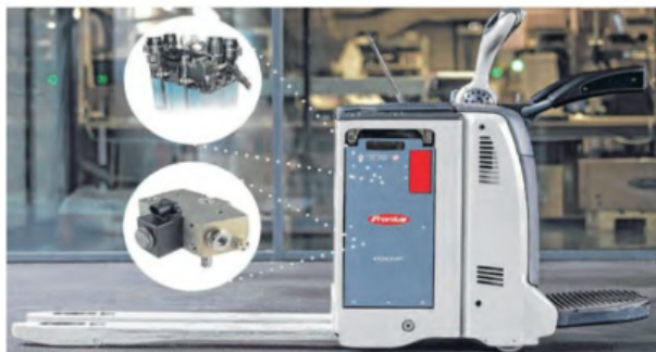
Das Tankventil mit integriertem Druckregler (Kreis unten) und das Medienmodul (Kreis oben) sind Schlüsselkomponenten des Brennstoffzellensystems. © Fronius
